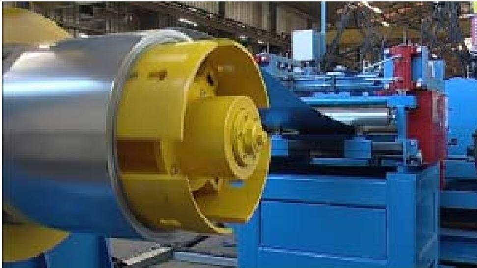
Blechrolle läuft in die Stanzmaschine ein.
